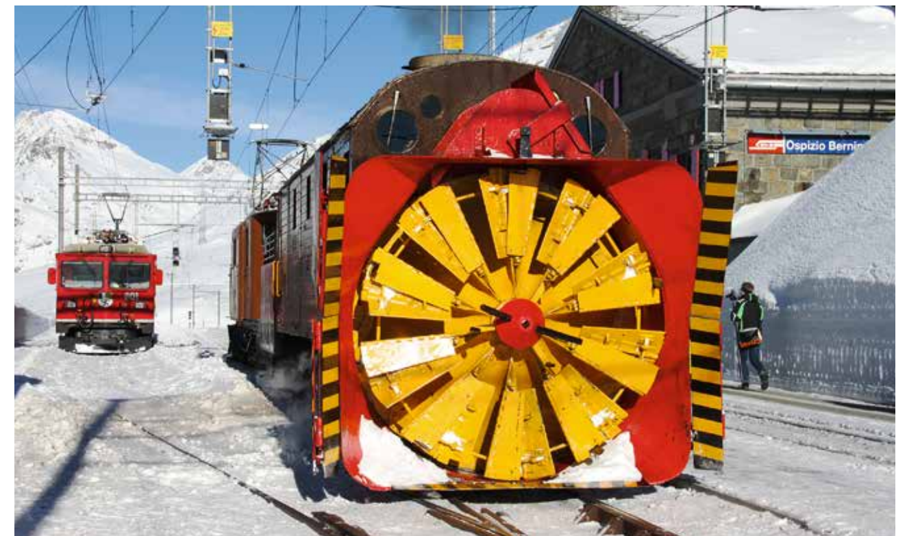
Die RhB Xrot Dampfschneesleuder steht seit über 100 Jahren im Einsatz.
